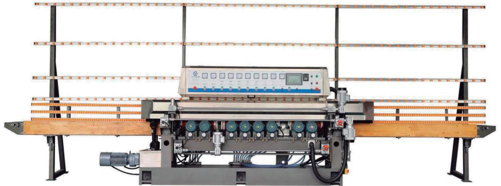
La CYZM-9325 es una canteadora rectilínea de alto rendimiento diseñada para el procesamiento de vidrio plano con bordes rectos y biseles a 45°. Gracias a su estructura robusta de hierro fundido, componentes de precisión y operación automatizada, permite realizar desbaste, afinado, pulido y biselado en un solo ciclo. Durabilidad y alta calidad en el acabado del vidrio.
